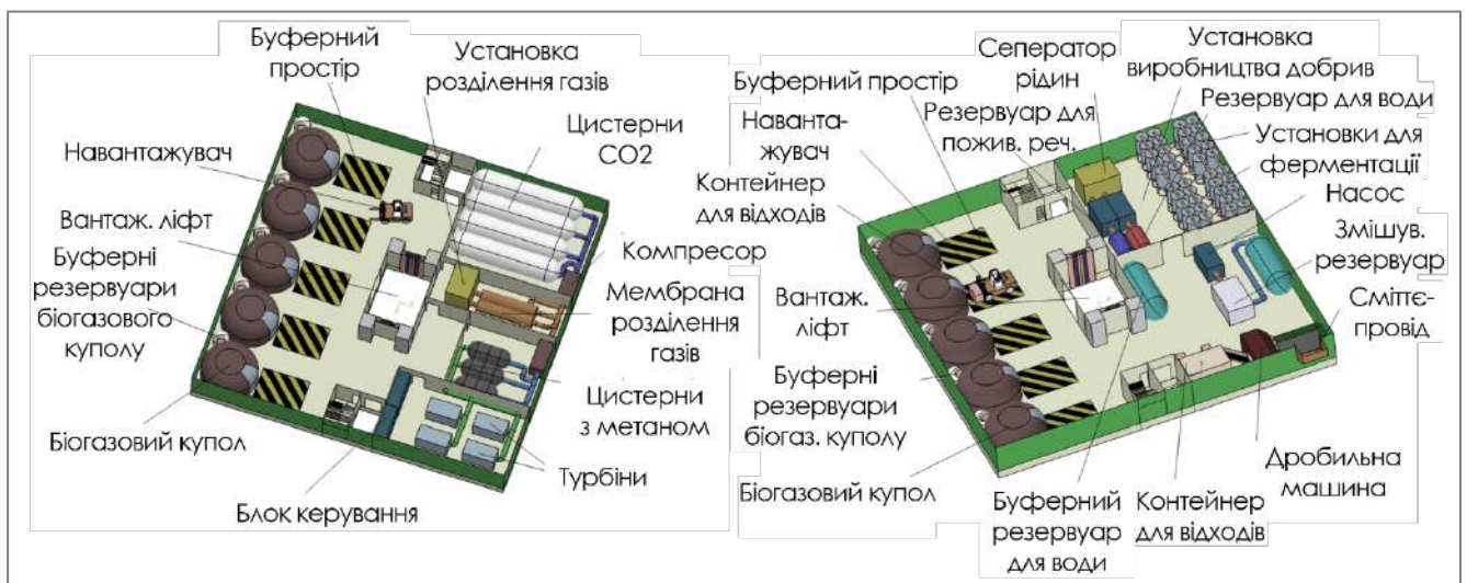
Рис. 3.2.10 Об'ємно-планувальна схема технічних приміщень для обробки біовідходів з метою отримання поживних речовин, електроенергії та вуглекислого газу методом анаеробного бродіння
