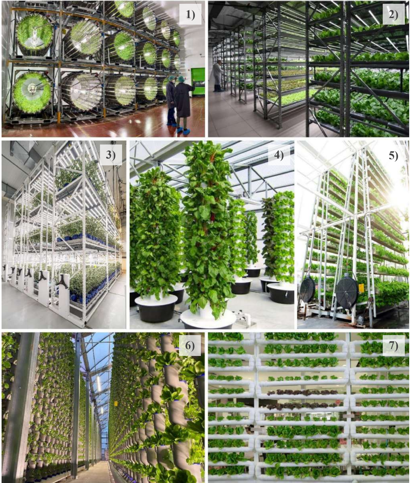
Рис. В.1 Приклади основних типів конструктивних конфігурацій гідропонного обладнання
