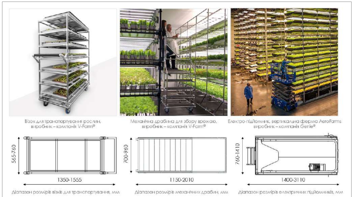
Рис. 4.3.3 Приклади та геометричні параметри допоміжного обладнання необхідного для приміщення вирощування у вертикальних фермах [272–288]
