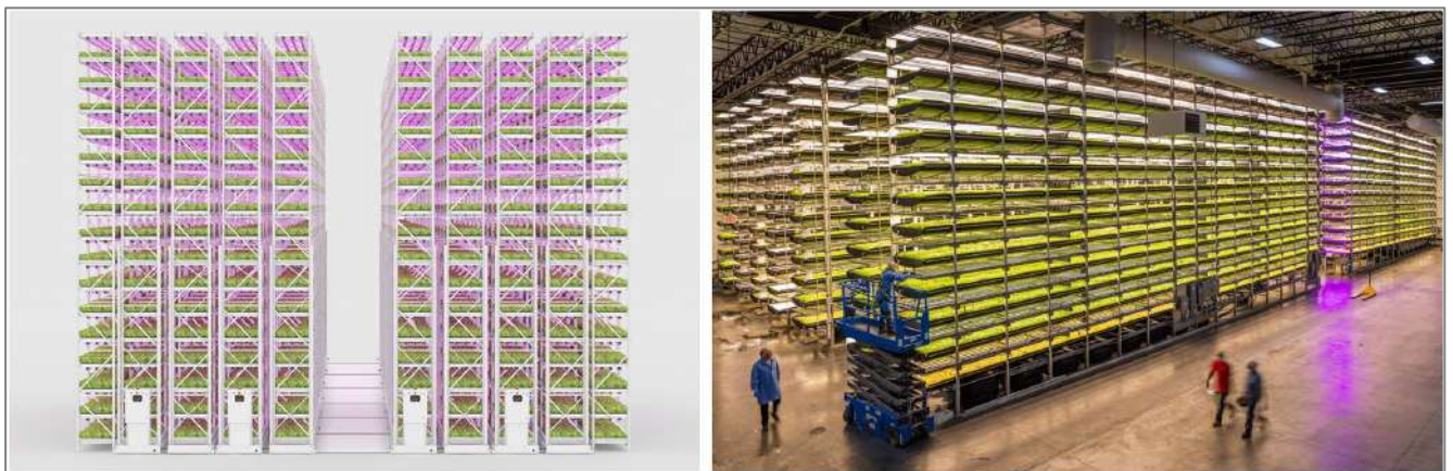
Рис. 4.3.4 Приклади висотних багатоярусних стелажних модулів для вертикального фермерства
