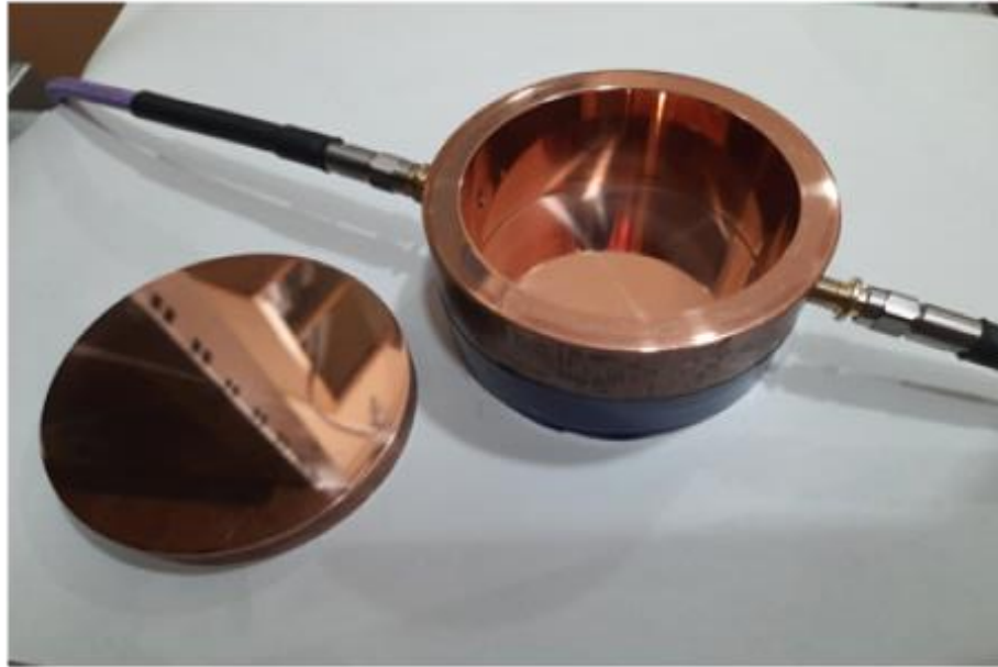
Рис. 5.2. Порожній мідний циліндричний резонатор з резонансною частотою 3,3 ГГц та кришка до нього, коаксіальний ввід та вивід надвисокочастотної енергії
