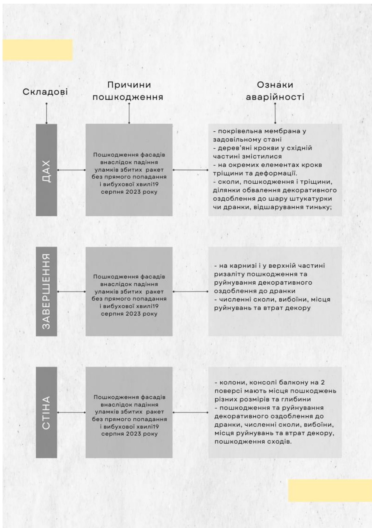
Рис.3.7. Модель фіксації руйнувань Будинку вчених в Одесі
