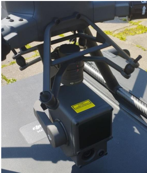
Рис.4.6. Зовнішній вигляд повітряного лазерного сканера DJI Zenmuse L2
