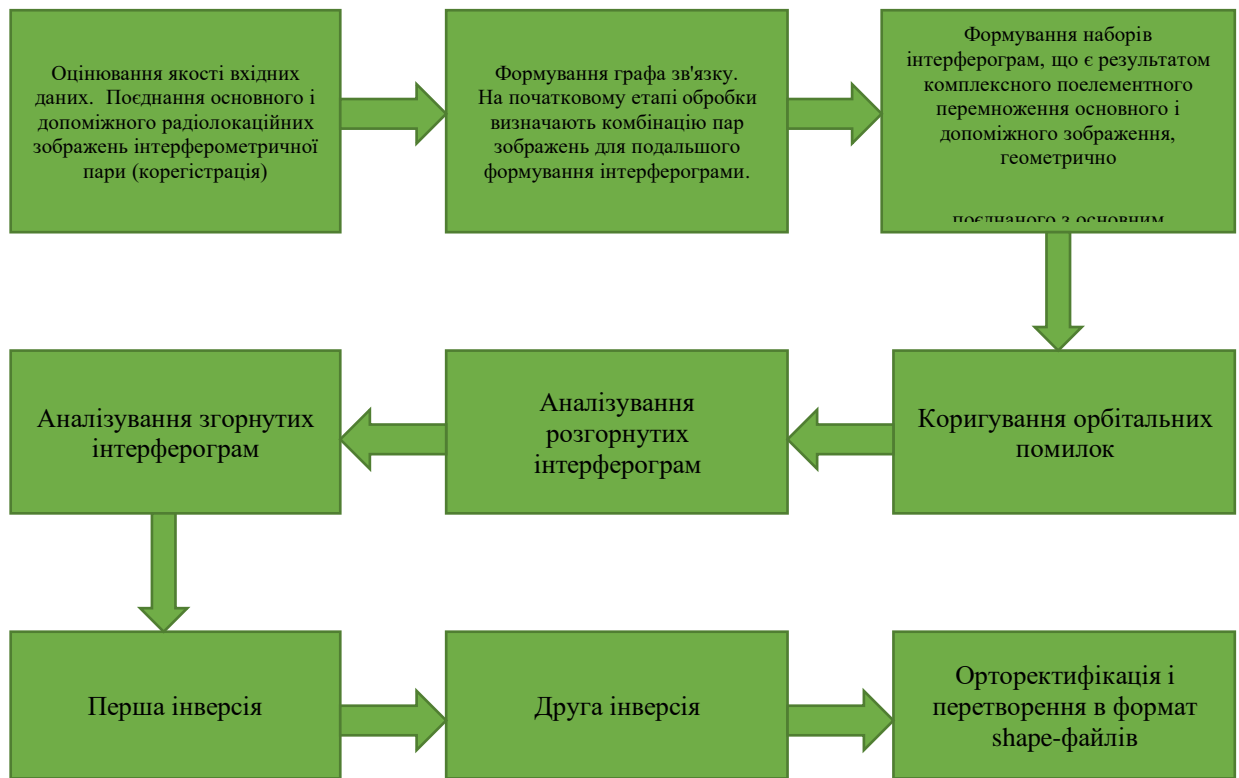
Рис. 2.5. Технологічна схема реалізації методу SBAS
