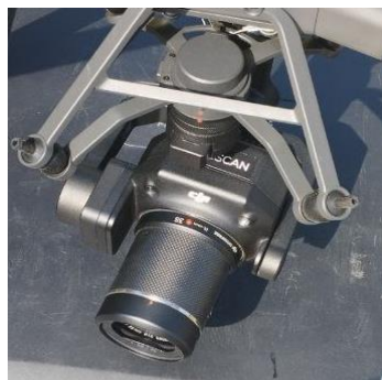
Рис.4.2. Зовнішній вигляд цифрової знімальної камери DJI Zenmuse P1 на підвісі БПЛА
