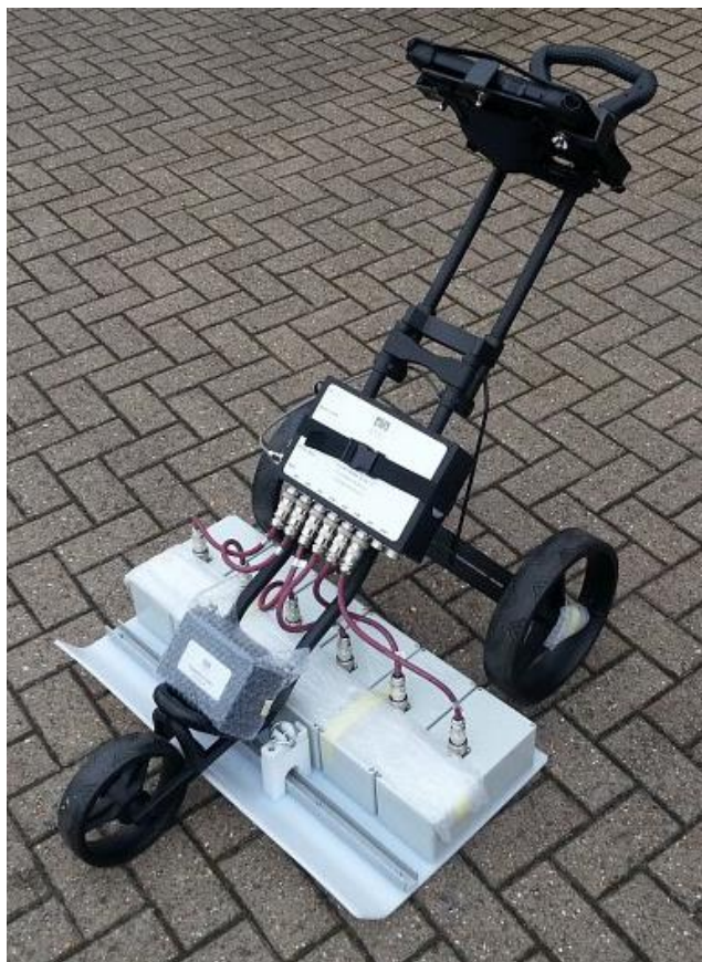
Рис. 3.22. Використаний георадар - UTSI GV3_1
