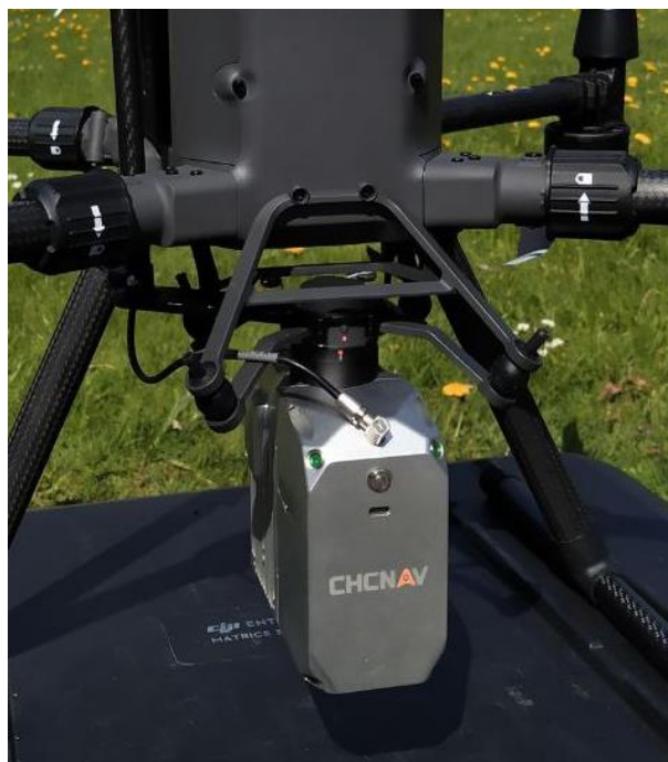
Рис.4.7. Зовнішній вигляд повітряного лазерного сканера CHCNAV Alpha Air 450
