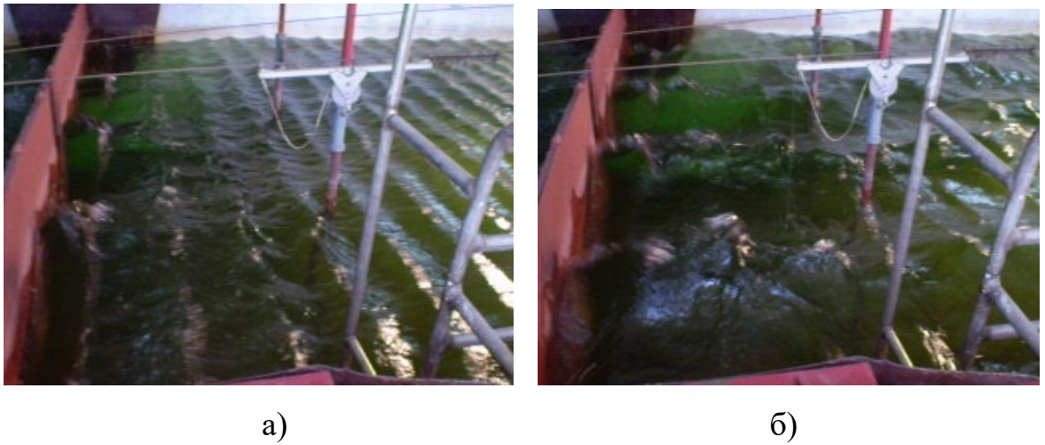
Рис. 3: Хрестоподібні хвилі (а) хрестоподібні хвилі, що зароджуються; б) встановлені хрестоподібні хвилі
