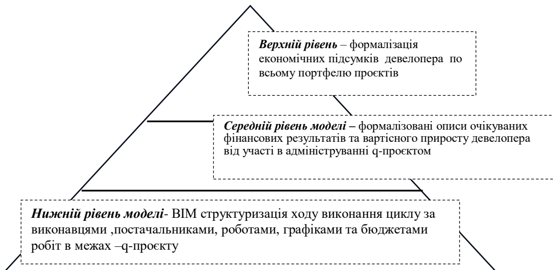
Рис.2.1. Трирівнева стратифікація BIM-моделі, яка забезпечує формалізований опис поточних та стратегічних підсумків операційної діяльності ДК при адмініструванні та впровадженні портфеля проектів.
