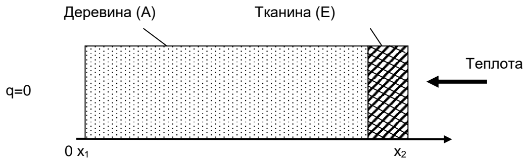
Рис. 1. Теплова схема стінки дерев'яної конструкції
