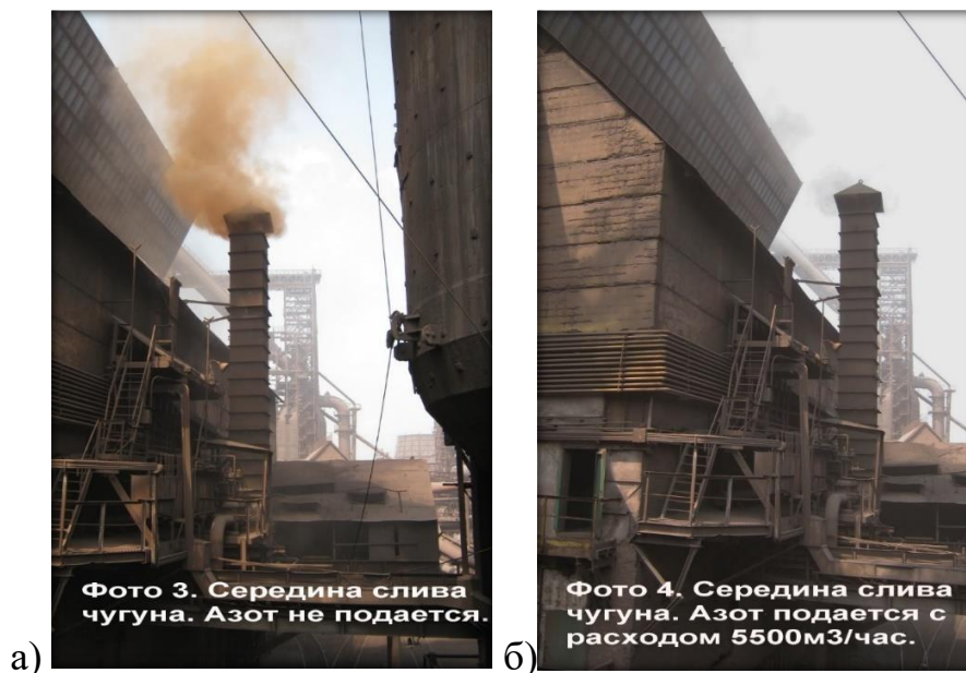
Рис. 4 Вигляд димової труби при випуску: а – без застосування азоту; б – при подаванні азоту
