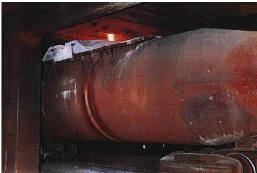
Рис. 2. Розливка чавуну в міксерний чавуновоз на ливарному дворі доменної печі в Німеччині. Завдяки застосуванню азоту викид бурого диму практично відсутній [7].
