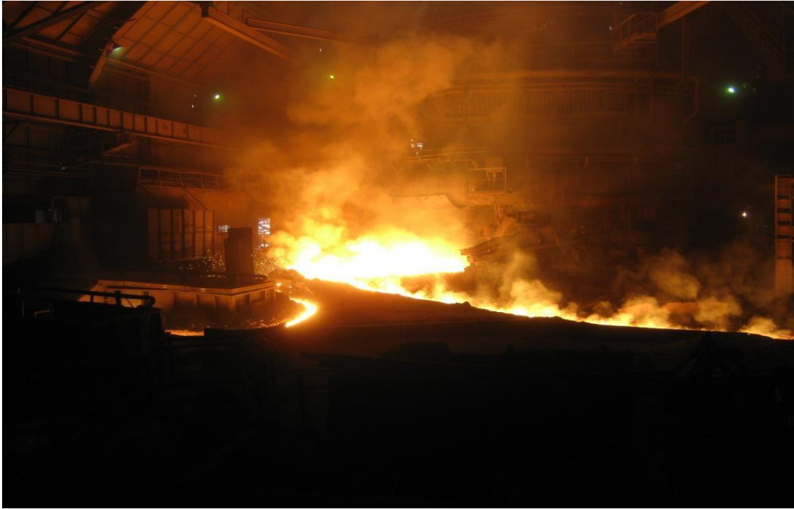
Рис.1 Випуск чавуну з доменної печі на одному з Маріупольських заводів. Видно потужний викид бурого диму.
