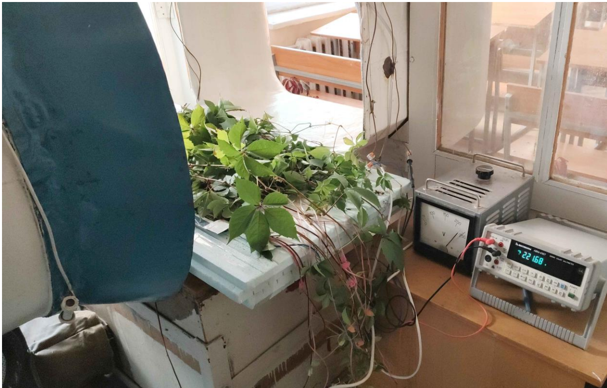
Рис. 1. Дослідження горизонтального озеленення в аеродинамічній трубі
