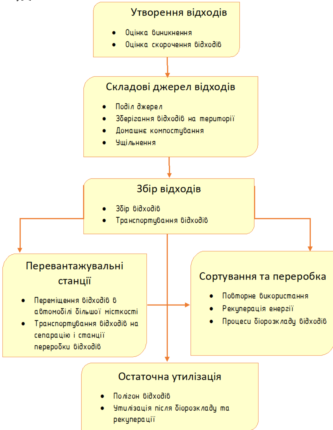
Рис. 1. Схема взаємозв'язків між функціональними елементами інтегрованої системи управління твердими відходами.
