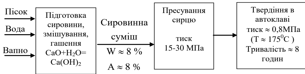
Рис. 2. Загальна схема виробництва силікатної цегли [7]
