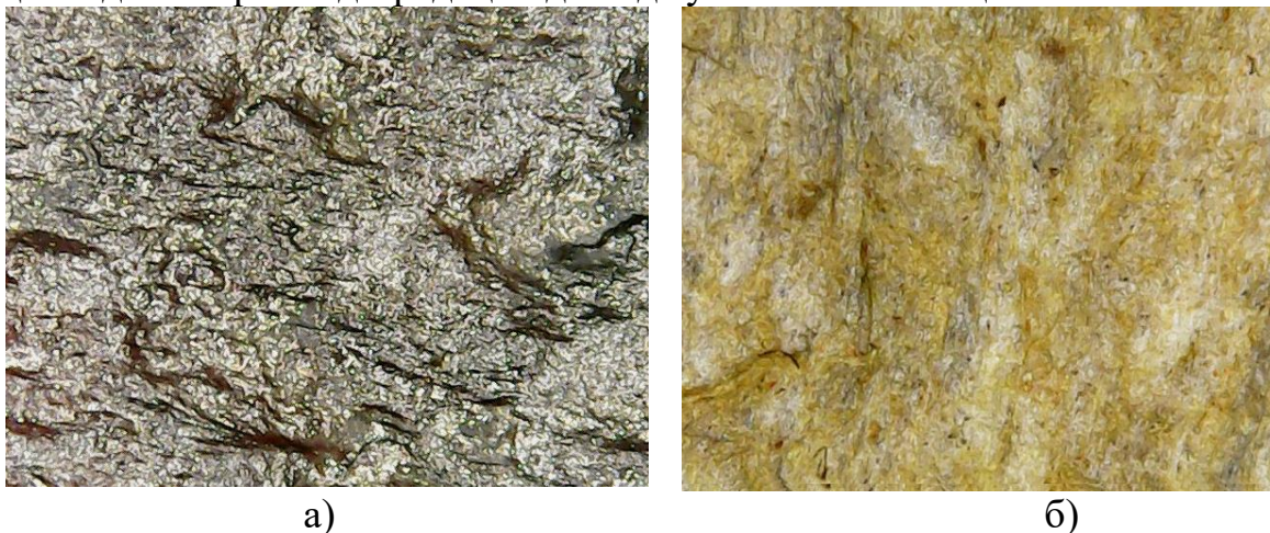
Рис.1. Мікрофотографії матеріалів виготовлених на основі композицій ПВС/Кр методом екструзії до (а) та після (б) впливу навколишнього середовища протягом 5 місяців з обробкою йодом.
