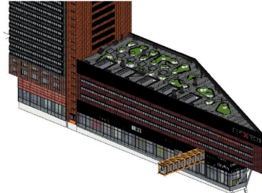
Рис.1. Торгово-розважальний комплекс «Перехрестя» в м. Дніпро, з розташованим на даху однієї з секції системи «Зеленої» покрівлі S=1200\text{м}^2 .
