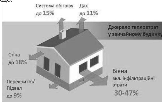
Рис 1. Джерело тепловитрат у звичайному будинку
