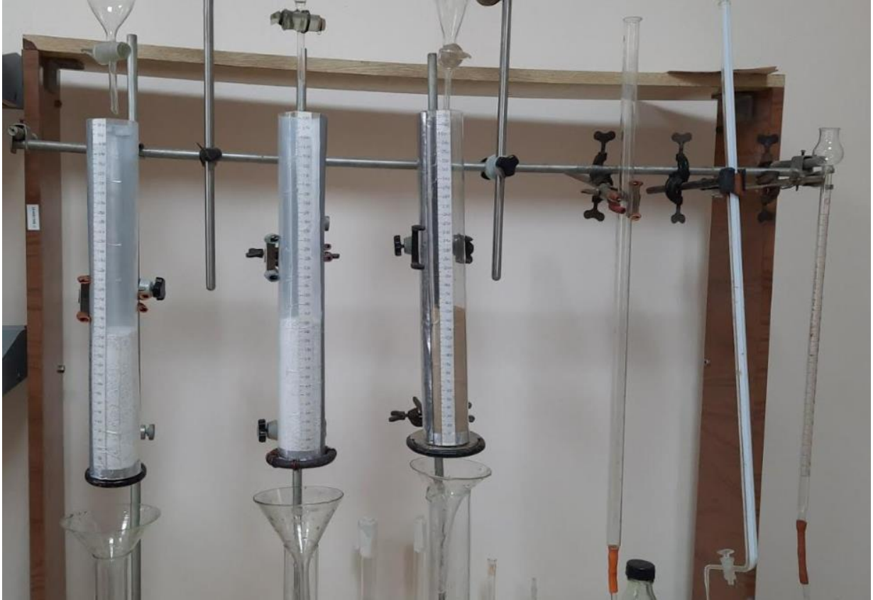
Рис. 3.5. Експериментальні колонки з глинистими зразками перед проведенням дослідю
