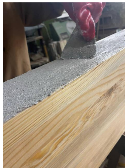
Рис. 3.21. Нанесення клею Sikadur-30 : а – нанесення клею Sikadur-30 на стрічку; б – нанесення клею Sikadur-30 на поверхню моделі.
