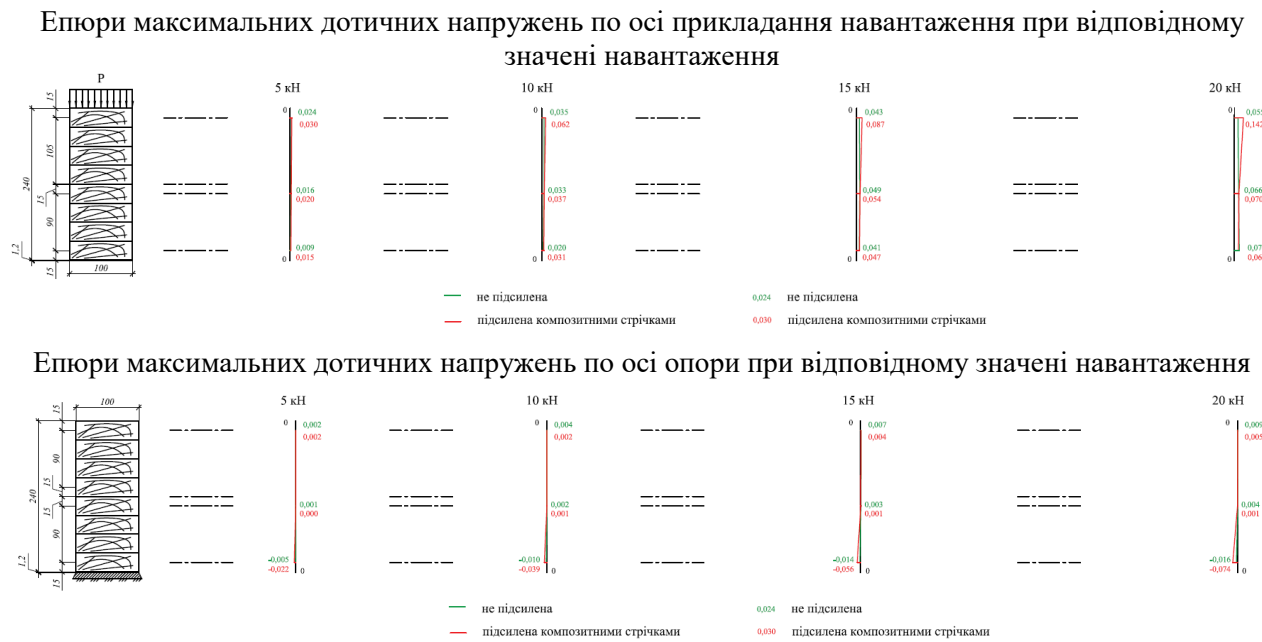
Рис. 3.28. Максимальні дотичні напруження в деревині досліджуваних перерізів експериментального зразка без підсилення та підсиленого композитними стрічками, при значенні навантажень: 5, 10, 15, 20 кН, на одну вісь прикладання навантаження.
