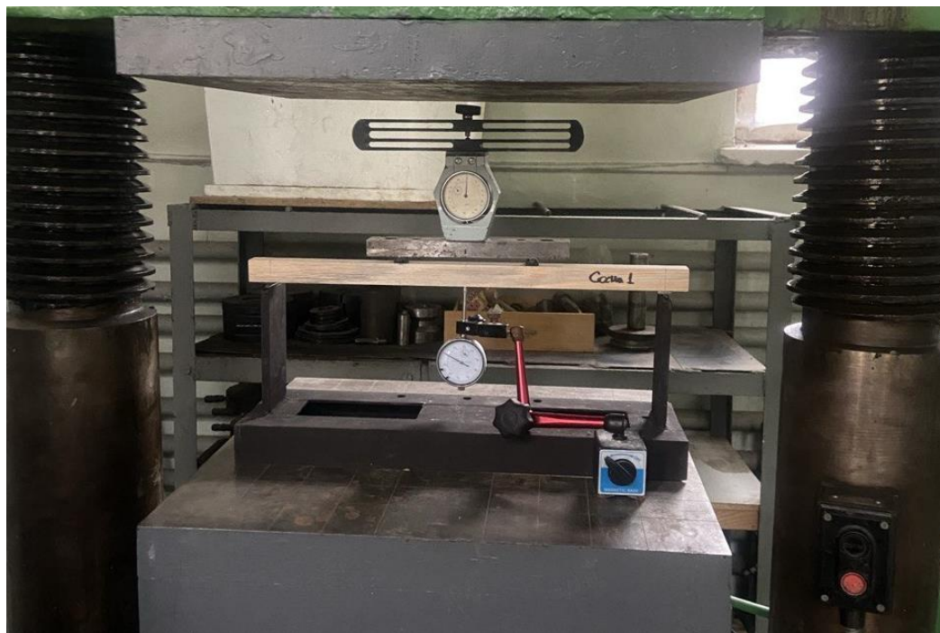
Рис. 3.5. Дослідний стенд для проведення експериментальних випробувань дослідних зразків для визначення модуля пружності деревини при згині.
