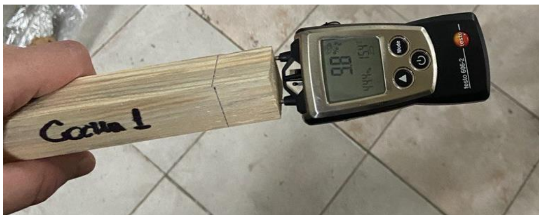
Рис. 3.3. Визначення вологості деревини вологоміром Testo 606-2 .
