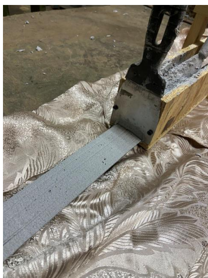
Рис. 3.21. Нанесення клею Sikadur-30 : а – нанесення клею Sikadur-30 на стрічку; б – нанесення клею Sikadur-30 на поверхню моделі.
