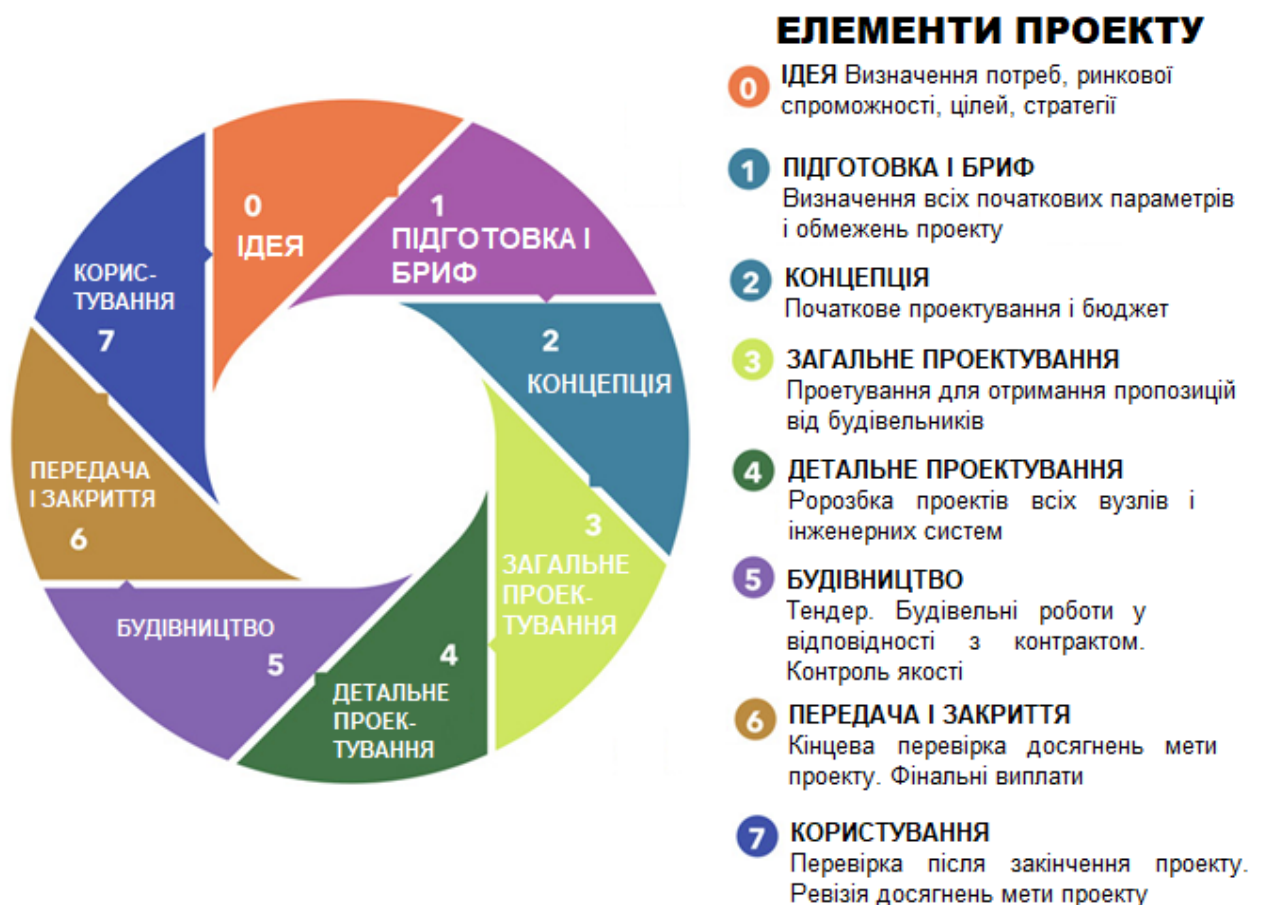
Рис. 1.2. Структура будівельного проєкту [43].
