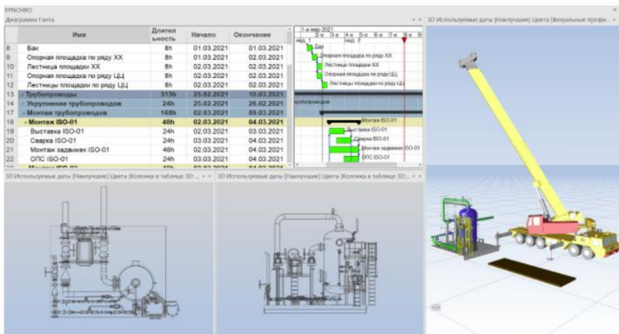
Рис.3.19. Ілюстрація планової 4D моделі з прив'язкою до термінів будівництва «К4»
