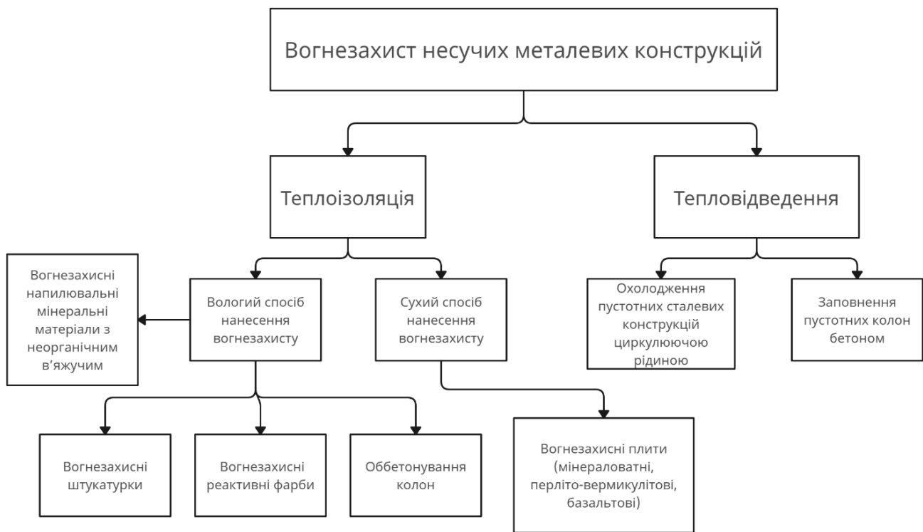
Рис. 1.5. Способи вогнезахисту сталевих несучих конструкцій
