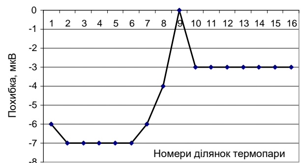
Рис. 7. Невиключена похибка від неоднорідності ТЕП з КПТП
