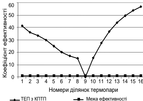
Рис. 8. Зміни профілю температурного поля, вище яких слід використати ТЕП з КПТП
