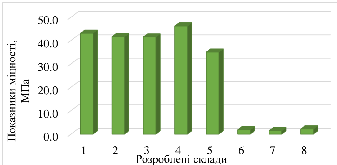
Рисунок 3.11 - Показники міцності при стиску кислотостійких лужних цементів з додаванням тринатрій фосфату на 28 добу тверднення
